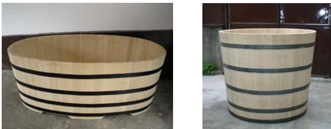
Fig. 2.9 Vase din lemn pentru fermentarea plămazii
